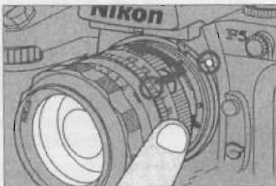
2 Umístěte objektiv do bajonetové objímky aparátu tak, aby byly nasazovací značky na objektivu i těle aparátu v jedné rovině. Dávejte pozor, abyste nestiskli spoušť a otáčejte objektivem proti směru hodinových ručiček, dokud nezaklapne na místo.
