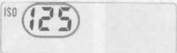
Při použití filmu bez kódu DX nastavte jeho ISO citlivost na zadním panelu LCD otáčením hlavního volče se stisknutým tlačítkem ISO (zastavit filmu). Při manuálním nastavení je použitelný rozsah ISO citlivosti filmu ISO 6 až 6400 po 1/3 stupně.
