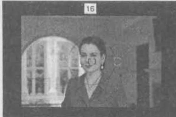
1 Umístěte značky pole ostření na objekt a lehkým stisknutím spouště spusťte práci autofokusu
