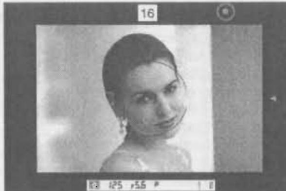
**Nepohyblivý objekt:** Lehce stlačte spoušť. Když je objekt zaostřen, objektiv se přestane pohybovat, v hledáčku se objeví ukazatel zaostření • a ostření se zablokuje. Můžete spustit závěrku. Pokud se objekt před spuštěním závěrky dá do pohybu, sundejte prst se spouště a potom opětovným lehkým stlačením znova zapněte autofokus.
