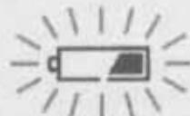
Pokud bliká, baterie jsou téměř vyčerpané. Otočte vypínačem na OFF (vypnuto) a vyměňte baterie za čerstvou sadu.
