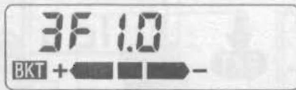
**2** Otáčením pomocného volíče se stisknutým tlačítkem BKT si zvolte požadovaný počet záběrů a kompenzační hodnotu z následující nabídky:
