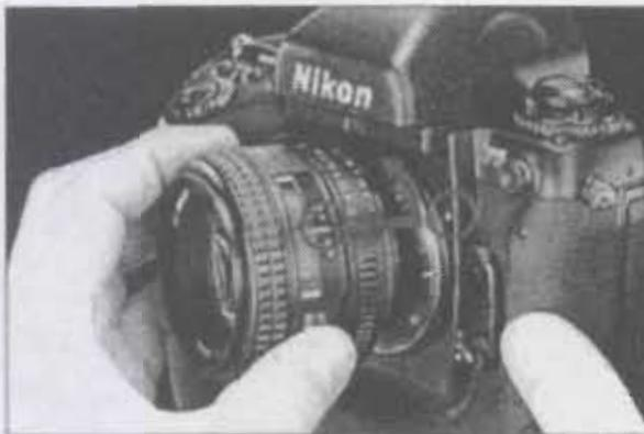
2 Umístěte objektiv do objímky upínacího bajonetu aparátu tak, aby byly nasazovací značky na objektivu i aparátu v jedné rovině. Dávejte pozor, abyste nestiskli tlačítka uvolňování objektivu a otáčejte objektivem proti směru hodinových ručiček, dokud nezypadne na místo.
