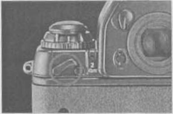
2 Ověřte si, že se převíjecí páčka 2... vrátila do původní polohy; pokud tomu tak není, posuňte ji zpět na místo.
