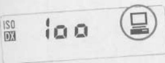
Když se F5 připojí k Windows 95R nebo osobnímu počítači systému Macintosh® doplňkovým spojovacím kabelem PC Link MC-33 nebo MC-34 a vybaví softwarem Photo Manager pro F5, mohou se informace, uložené v F5, natáhnout do vašeho osobního počítače. Tyto informace pak lze propojit s daty ze scanneru a editovat na vašem osobním počítači. Podrobněji viz uživatelskou příručku Photo Manager pro software F5.
